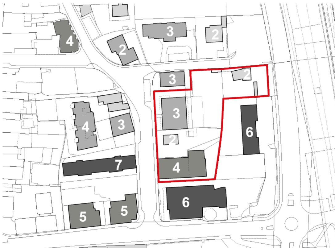
**Longueur maximale des éléments de façades :** il en va de même pour la limitation à 12 m. des longueurs maximales d'éléments de façades, illustrés par les témoins rouges sur le schéma ci-après. Dans de nombreux cas, le respect de cette disposition a été obtenu par de minimes décrochements de façades (quelques dizaines de centimètres)
